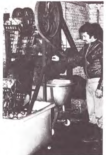
Mit dieser Maschine werden die Äpfel gewaschen und zerkleinert, damit sie nachher in Tücher eingewickelt in die Presse geschoben werden können.
